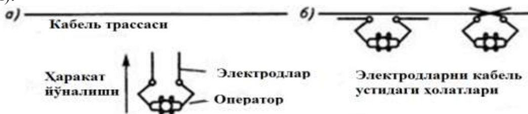
6-расм. Ер ости коммуникацияларини топишнинг биолокация усули.
