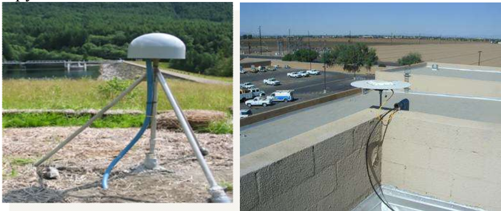
1-rasm. Joyga o'rnatilgan doimiy bazaviy stansiyalar
