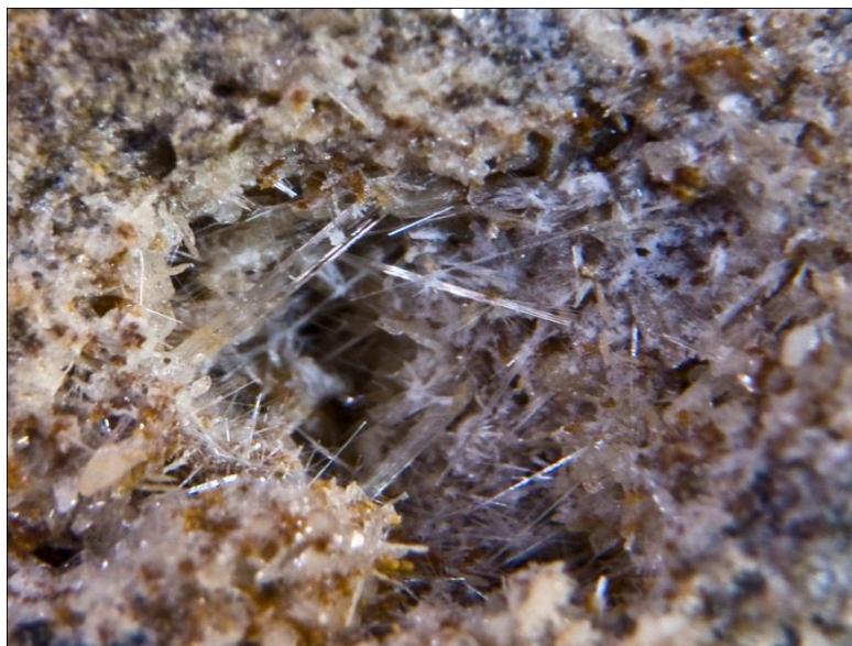
1-расм. Волластонитнинг микронинасимон тузилиши (1700 марта катталаштириб олинган).
