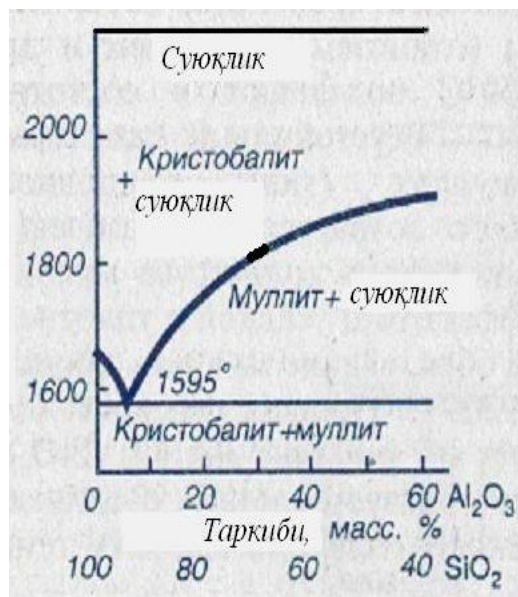
3.1-расм. \text{SiO}_2 - \text{Al}_2\text{O}_3 эритмаси ҳолати диаграммаси
