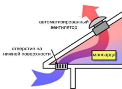
Рис. 2. Полностью автоматизированный мансардный вентилятор, снабженный солнечной батареей
