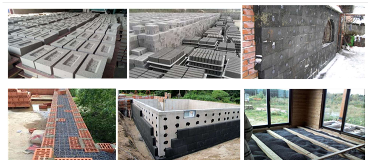
3-расм. Кўмир кули асосида олинадиган энергия тежамкор қурилиш материаллари ва уларнинг қўлланилиш соҳалари
