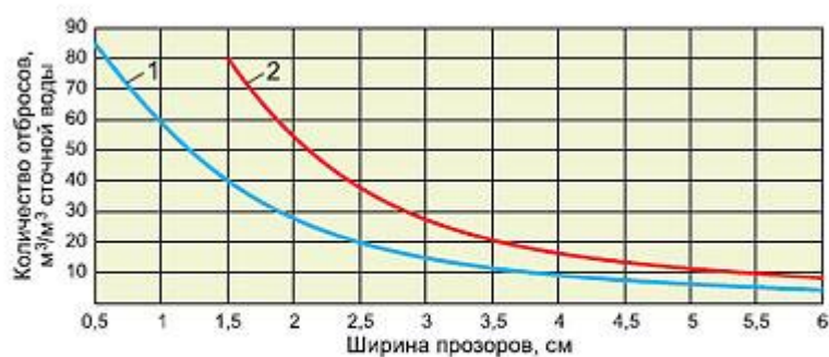
Рис. 2. Зависимость количества задерживаемых отбросов от ширины прозора решетки 1 – среднее значение; 2 – максимальное значение
