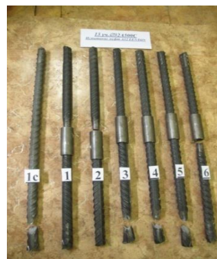
Рисунок 1. Соединение арматурных стержней фирмы CABR (а) и LENTON(б)
