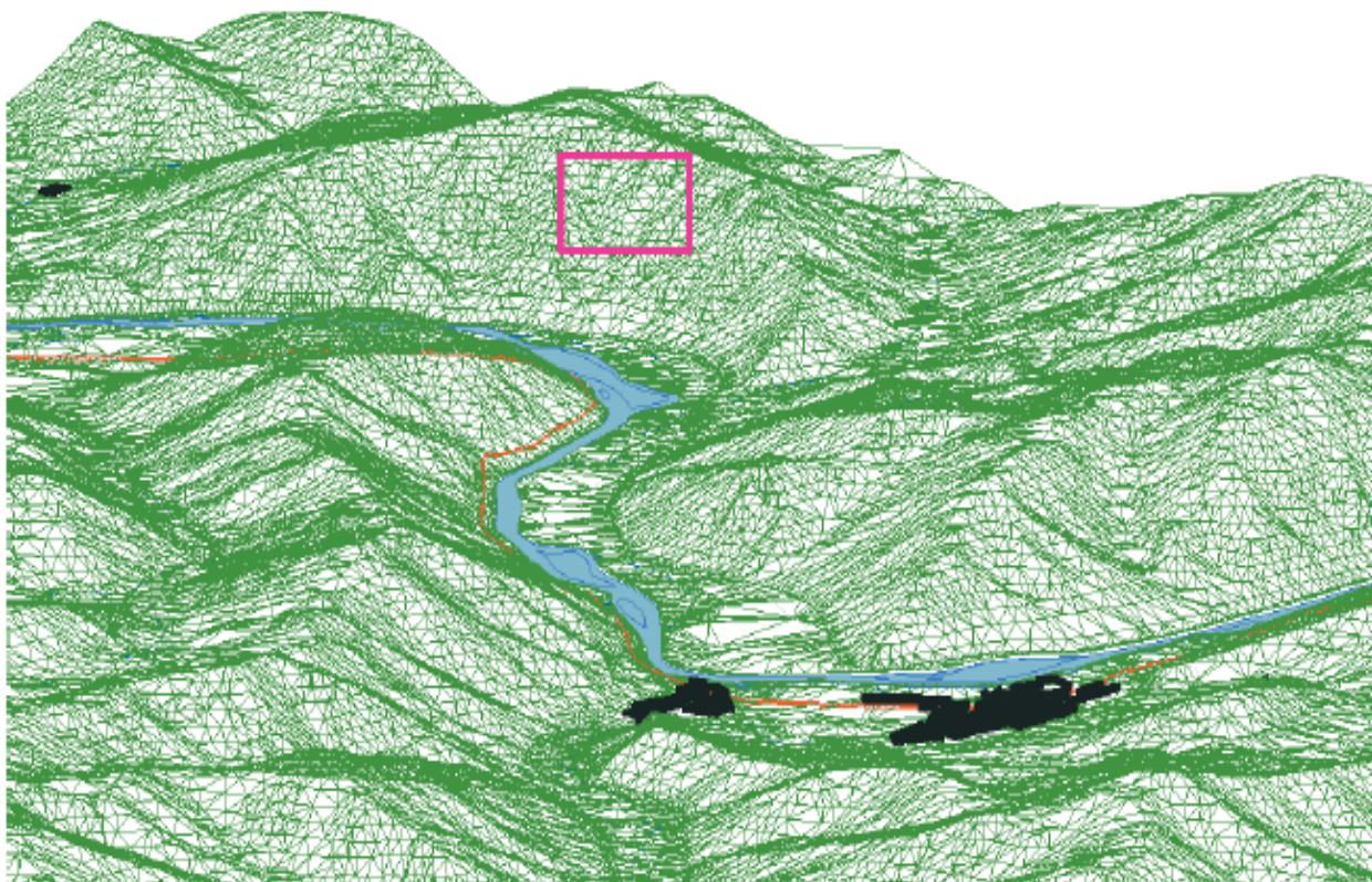
Рис. 4. Фрагмент трёхмерной модели рельефа, построенная на основе нерегулярной триангуляционной сети (TIN)
