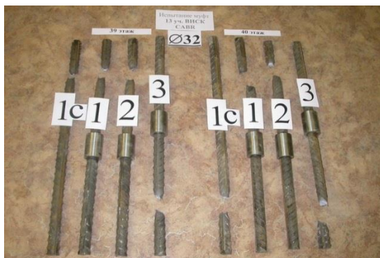
Рисунок 1. Соединение арматурных стержней фирмы CABR (а) и LENTON(б)
