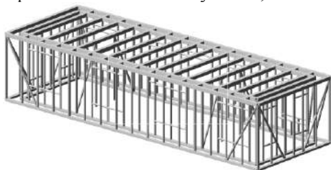
Рис. 1. Общий вид смоделированной системы по вариантам № 1, № 2 и № 3 (элементы фундамента, заполнение синчевого каркаса и элементы «черного» потолка условно не показаны).
