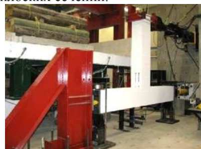
Рис 2. Установка для испытаний образцов и генерации динамических нагрузок [2].
