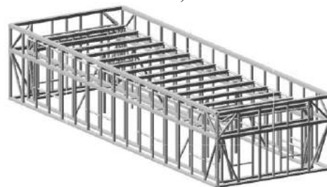
Рис. 2. Общий вид смоделированной системы по вариантам задачи № 4, № 5 и № 6 (элементы фундамента, заполнение синчевого каркаса и элементы «черного» потолка условно не показаны).
