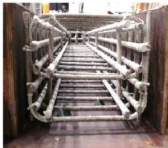
Рис. 1. Армирование образцов для исследования [2].
