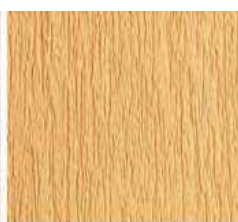
Штукатурка Ceresit CT 35 / CT 30, получена путем затираний пластиковым полутерком (теркой) в одном направлении
