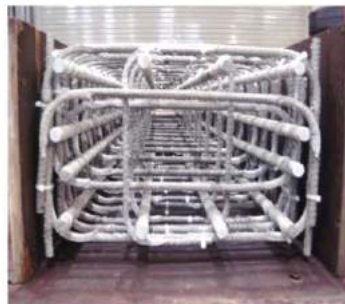
Рис. 1. Армирование образцов для исследования [2].
