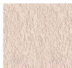
Штукатурка Ceresit CT 35/ CT 30, получена путем круговых затираний пластиковым полутерком (теркой)
