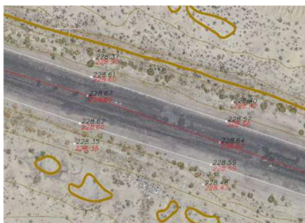
Рис 4. Ортофотоплан и цифровая модель местности
