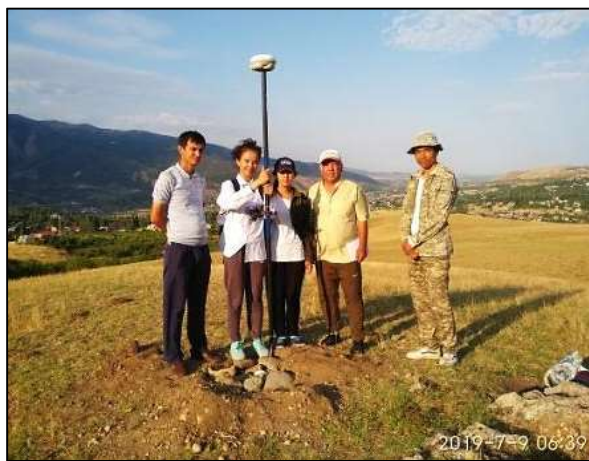
Рисунок 4. GNSS измерения контрольной точки на полигоне
