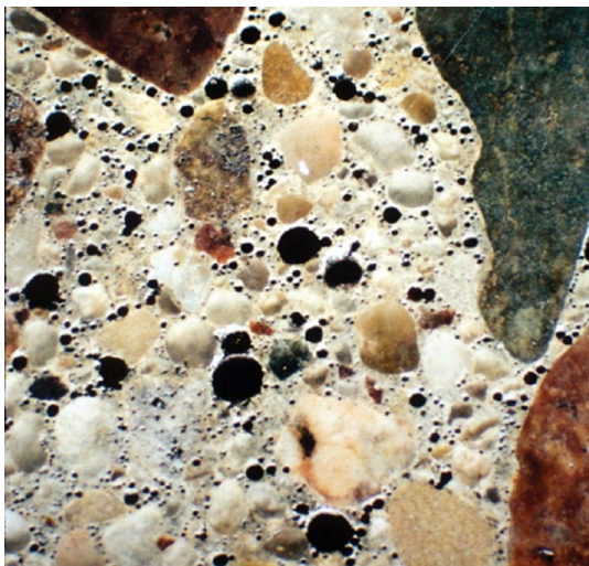
1-расм. Бетон таркибидаги ҳаво фазаси
