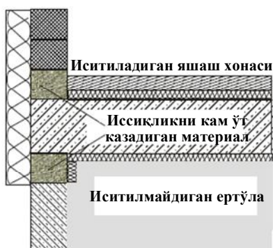
4-расм. Ертўла ташқи девори, ертўла ёпмаси ва биринчи қават ташқи деворларининг ўзаро туташган жойига иссиқликни кам ўтказадиган материал (термовкладыш) билан алмаштириб “иссиқлик кўприги” ги йўқотилган
