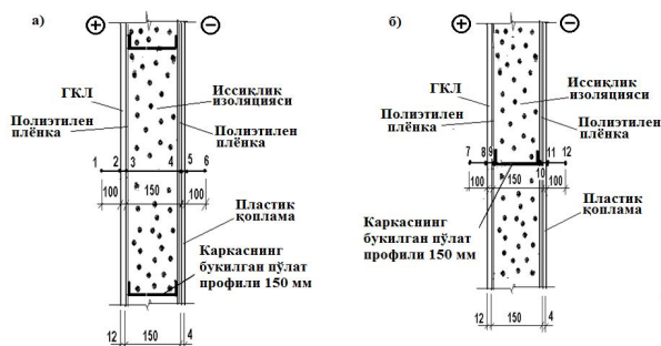
2-расм. Тажириба девори фрагментида термодатчикларнинг ўрнатилиш схемаси: а – пўлат профил бўлмаган кесим бўйича; б – пўлат профил бўлган кесим бўйича; 1...12 – термодатчиклар рақами.
