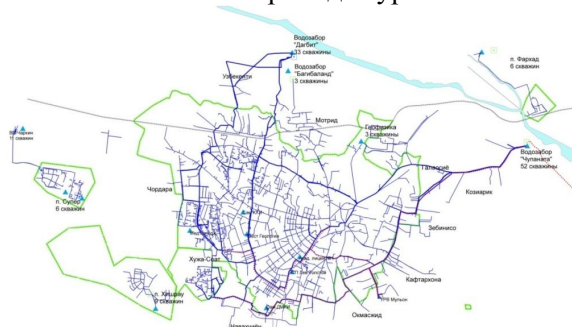
1-расм. Асосий сув манбалари ва насос станциялари кўрсатилган Самарқанд шаҳрининг сув таъминоти тизими шакли.
