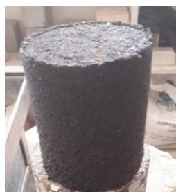
2-rasm. GOST 12801-98 bo'yicha 100 gr rezina granula qo'shib tayyorlangan asfaltbeton na'munasi
