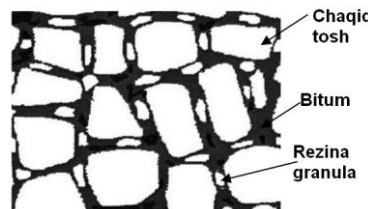
3-rasm. Asfalt beton qoplamasiga rezina granula qo'shilgan vaqtidagi zichlanganlik strukturasini ko'rsatuvchi diagramma. Diagrammada Chaqiq tosh, Bitum va Rezina granula qatlamlari ko'rsatilgan.
