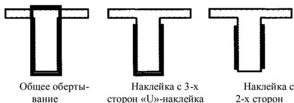
Рис. 1. Схемы наклейки УПВМ при усилении сечений.
