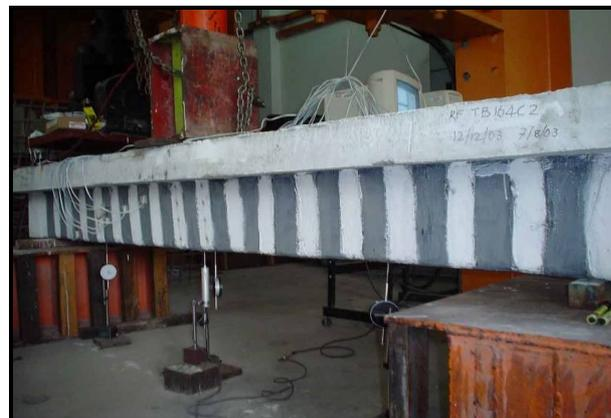
**Рис. 6.** Общий вид испытания тавровой балки при трехточечном изгибе ( $a_v/d = 4.0$ ).
