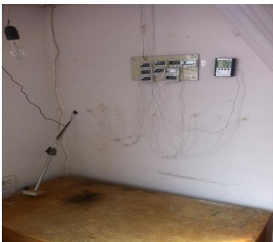
Рис.3. Определение температуры в толще наружного угла.
