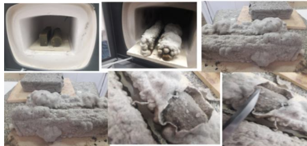
2.-расм. Ёғочга волластонит асосидаги янги оловбардош таркиб билан қайта ишлов бериш бўйича эксперимент тажриба натижалари тасвирланган.
