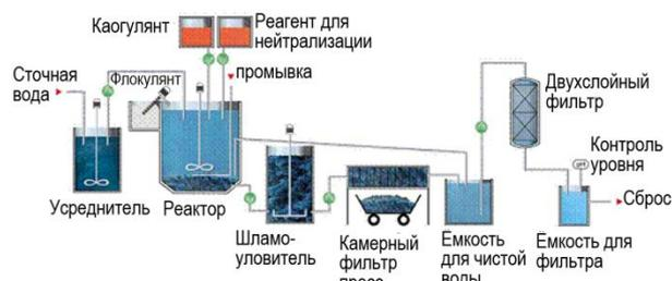
Рис.1. Технологическая схема процесса очистки сточных вод гальванического производства
