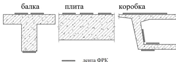
Рисунок 1. Возможные места приклеивания лент FRP при усилении железобетонных балочных и плитных несущих конструкций.
