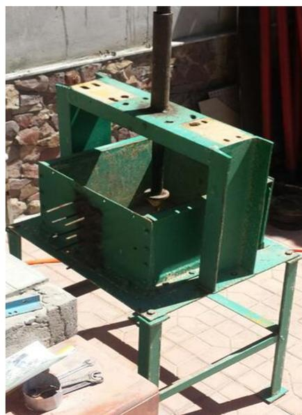
1-рис. Испытательный лоток для модельных испытаний прессиометра.
