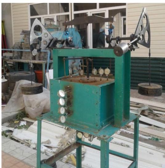
Рис. 2. Схема установки маячков для измерения перемещений, общий вид установки измерительной аппаратуры: 1-объёмный лоток размерами  $A \times B \times H=45 \times 45 \times 30$  см; 2-нижний штамп прессиометра; 3-верхний штамп прессиометра; 4-тарированный мелко зернистый песок; 5-крупнозернистый песок; 6-мессуры;  $h_{I-V}$ -горизонтально направленные маячки.
