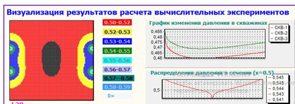
Рис. 6. Система разработки газовой залежи с двухсторонним контурным заводнением при разных дебитах центральных скважин
