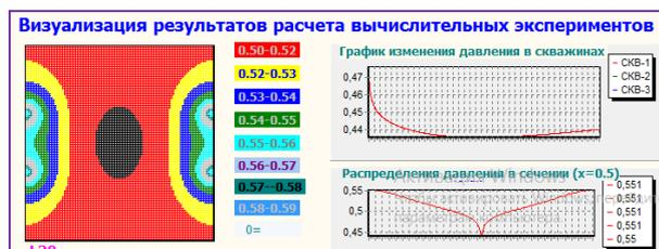
Рис. 3. Динамика изменения давления в газовой залеже при двухсторонним заводнением.  $\mu_r = 0,05 \text{ cПз}$
