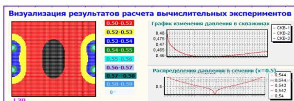
Рис. 5. Динамика изменения давления при разработке газовой залежи с двухсторонним заводнением прицентральными скважинами одинаковых дебитов
