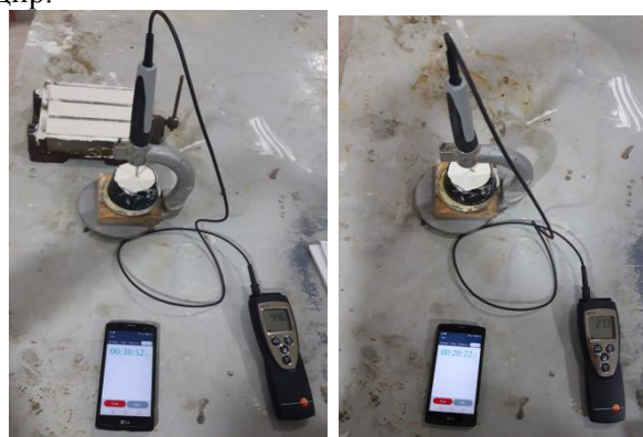
2-расм. Г5 ва Г6 маркадаги қурилиш гипсининг гипсининг иссиқлик ажраб чиқишини аниқлаш. а) Г5 ва б) Г6.
