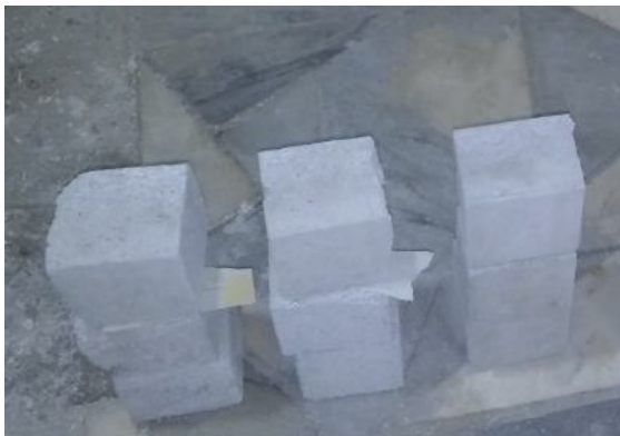
Расм. Эгилишга ва сиқилишга мустаҳкамлигини синаш учун тайёрланган фиброгазобетон намуналари.
