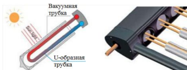
Рис.3. Вакуумный солнечный коллектор с U-образными трубками
