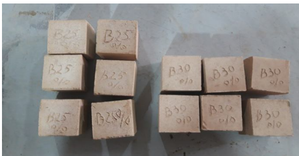
1-rasm. Shisha chiqindilari 25% va 30% keramik plitkani fizik-mexanik xossalarini o'rganish uchun na'munalar.
