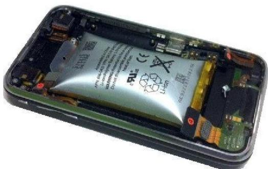
Рис. 3. Тепловой разгон на примере аккумулятора мобильного устройства
