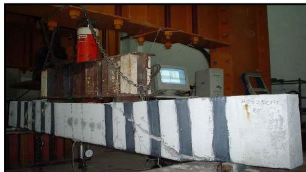
Рис. 2. Испытание экспериментальной прямоугольной балки при двухточечном изгибе
