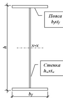
Рис. 1. Сечение составной балки
